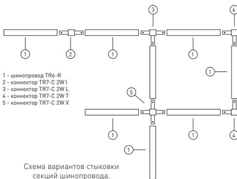
С помощью дополнительных коннекторов (поставляются отдельно) можно стыковать секции шинпровода в различных комбинациях.
