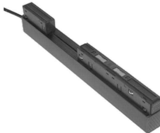
Скрытые драйверы представлены двумя моделями 100 и 200 Вт. Они устанавливаются заподлицо с краем шинпровода и не привлекают к себе внимания. Данные драйверы идеально подойдут для проектов, где в шинпроводе есть свободное место для их размещения.
