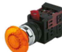
Б0045633 BBG30-AEA-K05E Кнопка AEA-22 "Грибок" d22мм 1з+1р Желтый Ø Установочного отверстия 22 мм
