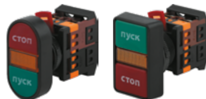
Б0045625 BBD11-APBB-K51E Кнопка APBB-22N "Пуск- Стоп" d22мм 240В 1з+1р Красный/Зеленый Неон 230В AC Ø Установочного отверстия 22 мм
