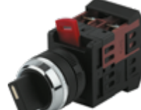
Б0045676 BSW10-AC-2-K02E Переключатель AC-22 на 2 фиксированных положения I-O 1з+1р Черный Ø Установочного отверстия 22 мм
