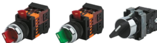
Б0045682 BSW10-ANCL-3-K04E Переключатель ANCL-22-3 на 3 фиксированных положения 240В I-O 1з+1р Красный неон 230В AC Ø Установочного отверстия 22 мм
