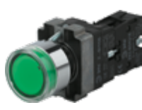
Б0045663 BBT50-BW-K06E Кнопка управления LAY5-BW3361 1з Зеленый LED 230В AC Ø Установочного отверстия 22 мм
